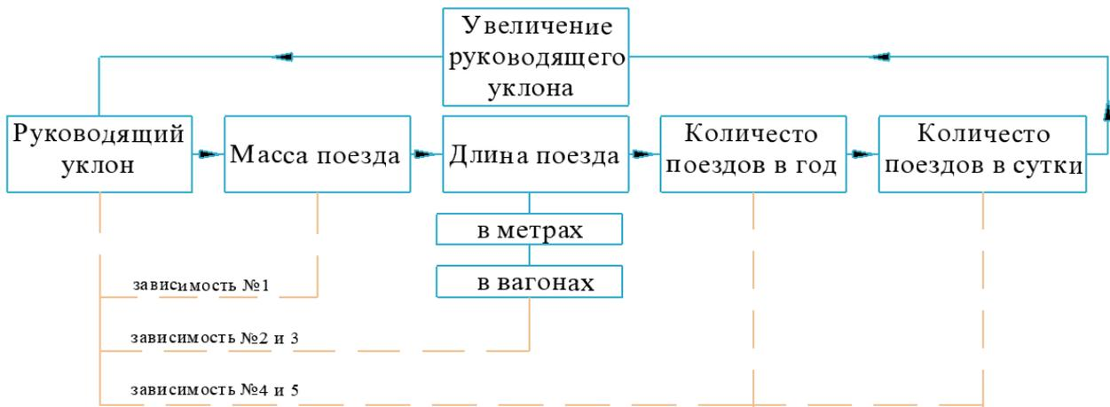
Рис. 1. Блок-схема для итерационного расчета основных параметров поездопотока
