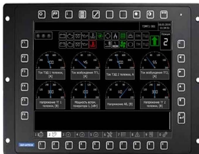
Рис. 3. Пример интерфейса приборной панели МПСУиД
