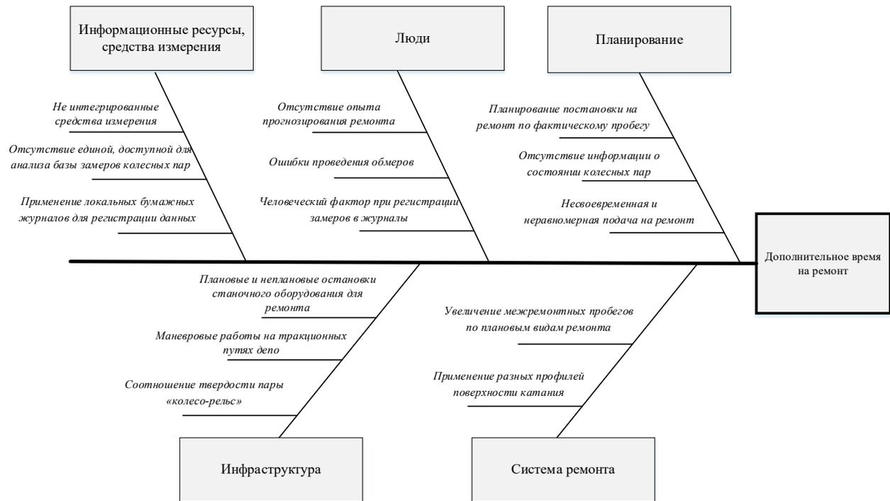
Рис. 2. Причинно-следственные связи факторов, влияющих на образование дополнительного простоя локомотивов на ремонте
