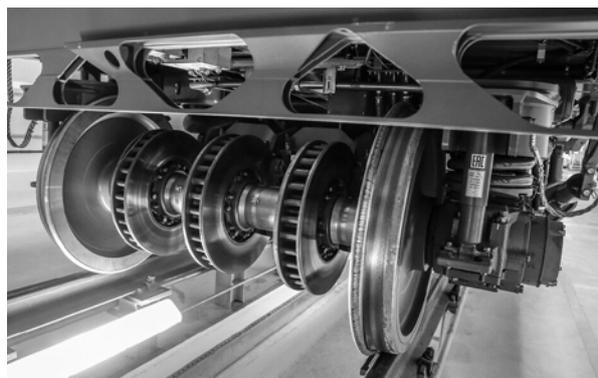
Рис. 8. Дисковые тормоза с вентилируемыми тормозными дисками
