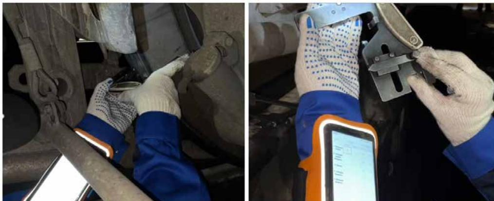
Рис. 4. Использование ТУ-18э при проведении замеров
