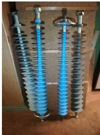
Рис. 2. Линейные изоляторы с RFID-индикаторами
