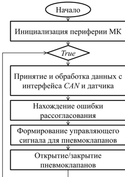
Рис. 5. Блок-схема основной функции программного кода
