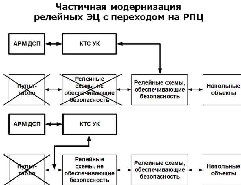
Рис. 5. Структурная схема частичной модернизации релейных ЭЦ
