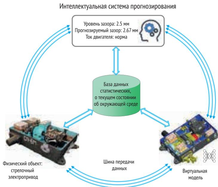
Рис. 1. Структурная схема ЦД СЭП
