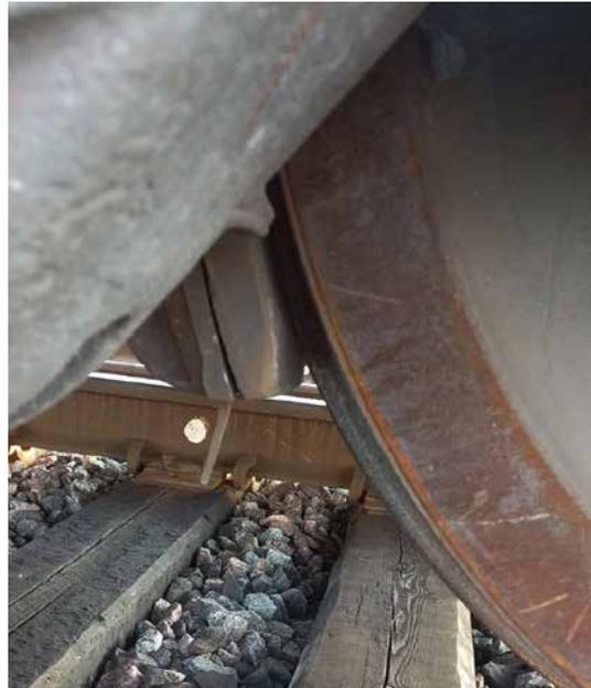
Рис. 3. Загнутая нижняя часть чеки в башмаке
